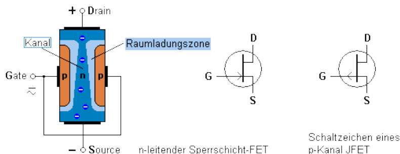
Abbildung 14: N-Kanal Feldeffekttransistor
