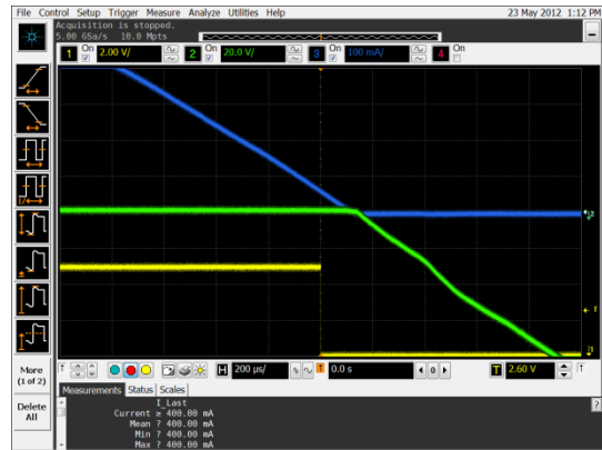
Abbildung 31: OPTO22 mit ohmscher Last im Ausschaltmoment
