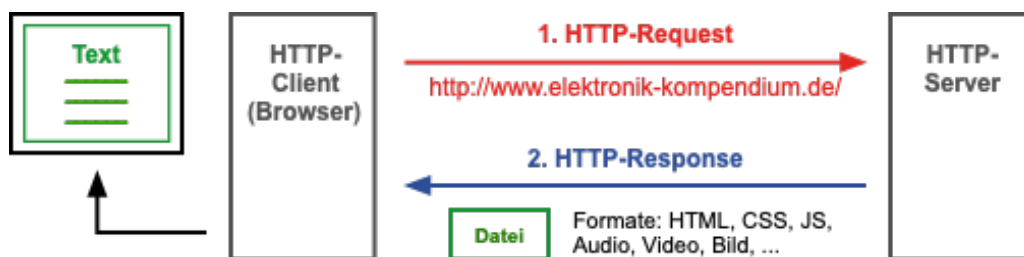
Abbildung 3.6: HTTP-Client-Server Kommunikation, Quelle: [37]
