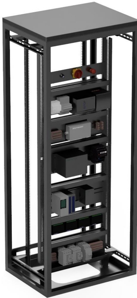
Abbildung 4.7: Der Schaltschrank in Fusion360 gezeichnet
