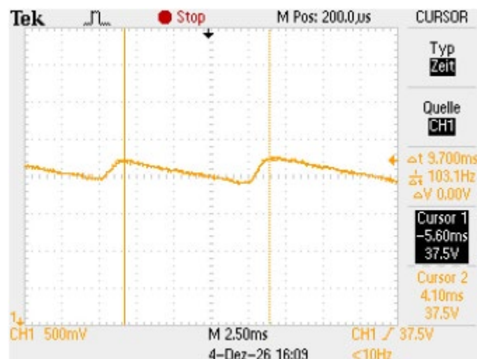
Abbildung 3.30: Beispiel für eine „unschöne“ Gleichspannung
