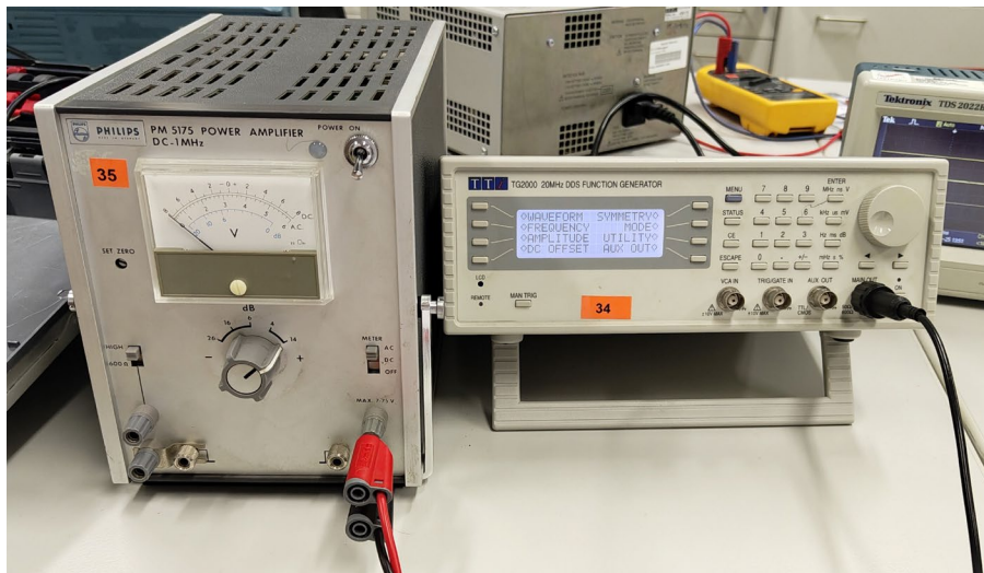
Abbildung 3.7: Funktionsgenerator mit Leistungsverstärker
